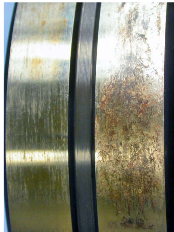
Ruggine da contatto sulla corrispondente superficie esterna dell'anello esterno
