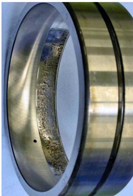
Sfaldamenti sulla pista dell'anello esterno
